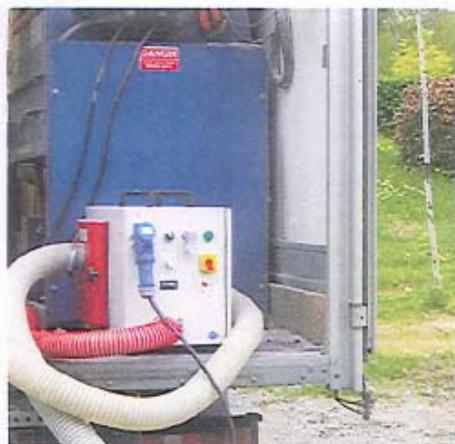
► Le réglage de la pression de la machine doit se faire entre 25 et 50 bar. La trémie de chargement peut contenir six sacs de ouate de 12,5 kg chacun.
